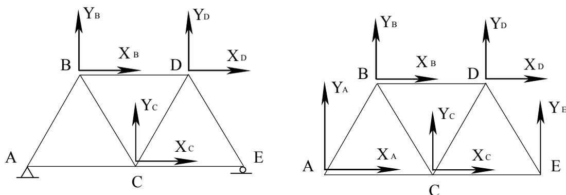
Сначала определим реакции опор. Принцип освобождаемости от связей позволяет заменить опоры  $A$  и  $E$  реакциями  $X_A, Y_A, Y_E$  и считать ферму свободной. В равновесии главный вектор и главный момент всех сил равны нулю:
